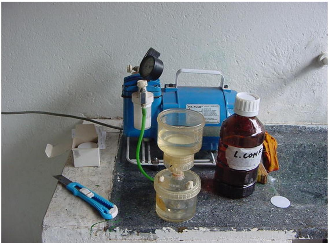
**Foto 5.8.** Equipamentos utilizados para filtragem de amostras de água.
